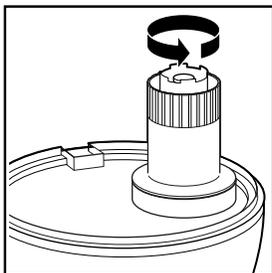
2. Remplir le réservoir à l'eau FRAÎCHE du robinet. NE PAS UTILISER L'EAU CHAUDE. S'assurer que le réservoir ne contient aucun débris.
