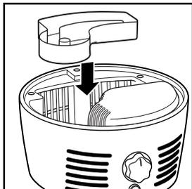
2. Placer le filtre sur le plateau à eau, conformément à l'illustration.
