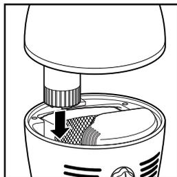
**REMARQUE :** Un peu d'eau est éjectée du réservoir et dans le plateau à eau lorsque le réservoir est mis en position.
