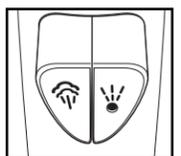
Boutons de vaporisation et de vapeur (sur les modèles sélectionnés)
