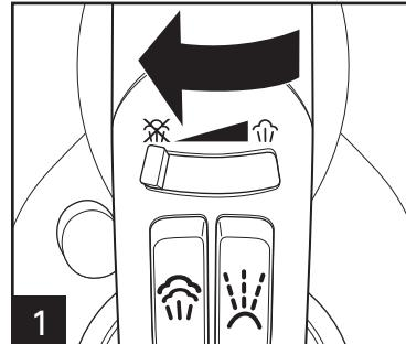
Régler le contrôle de vapeur réglable à (repassage à la vapeur).
