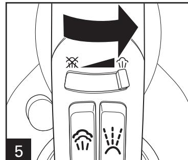
Régler le contrôle de vapeur réglable au niveau de vapeur désiré.
