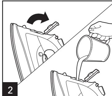
**Eau:** Utiliser de l'eau du robinet. Si l'eau renferme beaucoup de calcaire, alterner l'eau du robinet avec de l'eau distillée. NE PAS ajouter de d'empois ou de fragrance à l'eau du réservoir.
