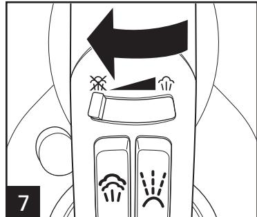
7 Régler le contrôle de vapeur réglable à (repassage à sec) pour mettre le fer hors tension.
