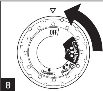
8 Tourner le cadran de commandes de température à OFF (arrêt).
