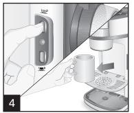
更换配件。用冷自来水运行两至三个循环。此时咖啡机已处于清洁状态,准备冲泡咖啡。
