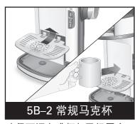
确保可调咖啡杯架已经固定, 并且已经扣在合适位置。
