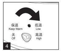
接通电源后,将旋钮拧至高 (HIGH) 档或者低 (LOW) 档进 行烹饪。炖好食物后, 可将旋 钮拧至保温 (KEEP WARM) 档 讲行保温。
