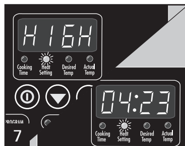
7 La pantalla alternará entre la configuración de calor y el tiempo restante. Al finalizar el tiempo de cocción, la olla de cocción lenta pasará automáticamente a la configuración WARM (calentar) y la unidad se apagará y mostrará OFF (apagado) después de un total de 14 horas. NOTA: Si se selecciona la configuración WARM (calentar), la unidad se apagará y se mostrará OFF (apagado) una vez transcurrido el tiempo seleccionado.
