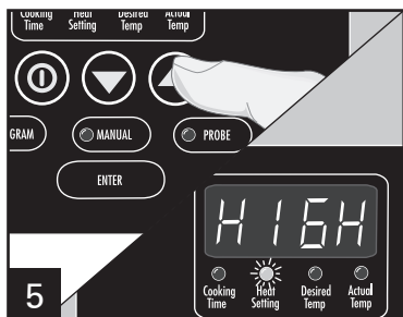
5 Presione las flechas para seleccionar la configuración de calor. Presione ENTER (ingresar) para iniciar la unidad y sonará un pitido de 3 segundos. NOTA: La unidad se iniciará automáticamente en 20 segundos si no se presiona ENTER (ingresar).
