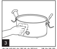
在洗碗机中清洗内胆时,请勿使用 "SANI"档,此档位的循环温度 可能会损坏本产品。
