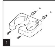
使用随附支承销和螺丝将壁挂架安装到 墙壁上。
