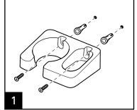
使用随附支承销和螺丝将壁挂架安 装到墙壁上。
