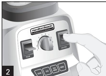
2 Pressione LIGA/PARA e, lentamente, gire o REGULADOR DE VELOCIDADE VARIÁVEL para a direita ou para a esquerda durante a mistura para aumentar ou diminuir a velocidade de mistura.
