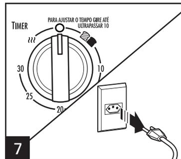
Quando terminar, gire o Timer para a posição **OFF (O)** (desligado) e retire o plugue da tomada.
