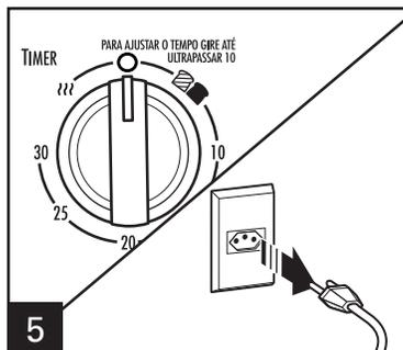
5 Quando terminar, gire o Timer para a posição **OFF (0)** (desligado) e retire o plugue da tomada.
