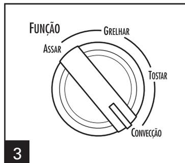
3 Gire o Seletor de Função para **CONVECÇÃO**. Gire o Timer para **CONVECÇÃO**. Gire o Timer até o nro 10 e pré aqueça por 5 minutos antes de colocar a comida no forno. Após pré-aquecer o forno, defina o tempo desejado, girando o Timer até passar de 10, e então defina o tempo de assamento desejado, ou gire o Timer até a posição {{{ (Manter Ligado).
