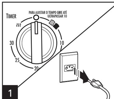
**1** Quando terminar, gire o Timer para a posição **OFF (O)** (desligado) e retire o plugue da tomada.
