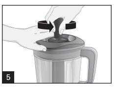
请将一只手压住盖子,使用搅拌棒将 旁边浓稠混合物推进搅拌杯内。
