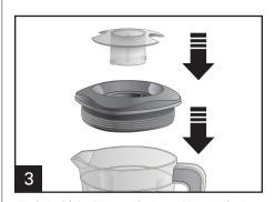
盖上搅拌杯盖子和加料口盖。将加料口盖插入到搅拌杯盖中并顺时针旋转固定。取下加料口盖,以使用搅拌棒或添加食材。
