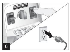
在搅拌周期结束时,旋转变速旋钮至1位置,并按启动/停止(令/©)开关以停止搅拌操作。使用底座右侧的重置/关闭(I/O)开关关闭料理机。搅拌后拔掉料理机的电源插头。
