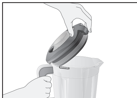
4. 此时用手指始终抓住卡扣，用拇指拖住杯盖直到杯盖完全打开。
