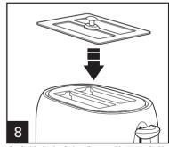
多士炉完全冷却后,可使用防尘盖 盖住防尘。
