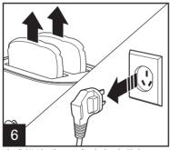
完成烘烤后,面包会自动弹出。 拔下多士炉电源插头。
