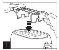
将烘烤架放在面包插槽上。
