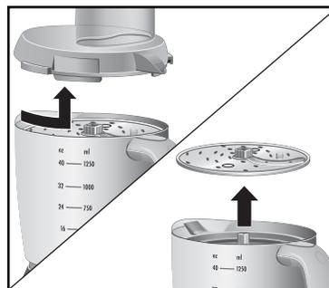
Remova a tampa. Remova o disco sem retirar o adaptador da haste do motor.
