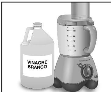
Encha o reservatório com 2/3 de xícara (160 ml) de vinagre branco. Monte o processador (ver página 7) sem adicionar a lâmina. Ligue o aparelho na tomada.
