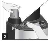
أمسك بالكأس أثناء الخلط. أوصل الخلاط بالتيار الكهريائي. اضغط زر التشغيل (|) أو زر التذبذب للطحن. أستعمل الخلاط دائماً فوق سطح ثابت
