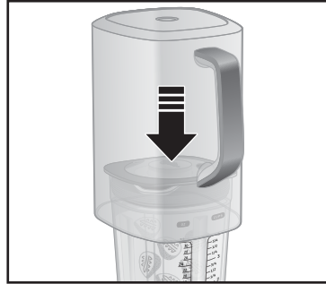
٦- ضع الغطاء المانع للضجيج فوق إناء الخلاط. ارفع الغطاء المانع للضجيج وغطاء فتحة التزويد لاستخدام عصا التحريك أو لإضافة المواد
