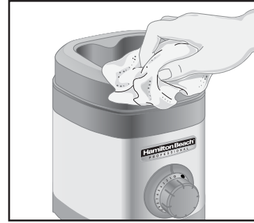
٣- امسح قاعدة الخلاط، لوحة التحكم، والسلك الكهربائي باستخدام قطعة قماش أو اسفنجية مبللة. لإزالة البقع العنيدة، استخدم مادة منظفة معتدلة وغير كاشطة
