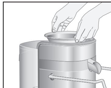
3. En posant les mains à l'extérieur du bord, abaisser fermement le panier-filtre pour le bloquer en place.
