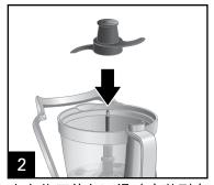
小心将刀片向下滑动安装到电机轴上。**注意**:一次仅可使用一个刀片或刀盘进行操作。
