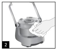
用湿布或海绵擦拭底座、控制 面板和电源线。如需要,请使 用温和的防磨损清洁剂。
