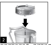
安装切丁块组件是,将切丁块刀盘向下安装再电机轴上,确保可取出网格刀靠近把手位置。然后将切割刀盘向下安装到电机轴上,直到与切丁块刀盘齐平。当使用送料口切丁块,切片或切丝时,确保搅拌杯内部没有其他刀片。
