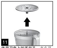
使用刀盘上的手指孔, 小心从 电机轴上取下刀片。
