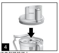
将搅拌杯放在底座上,把手面对自己。通过旋转调节杆,将刀盘调节到所需的厚度。有14个调节位置,调节范围从1/32到1/4英寸(0.8到6毫米)厚度。
