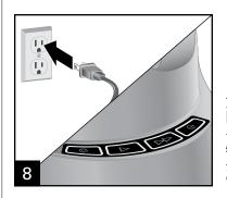
如果控制面板上的灯闪烁,说明食物料理机未正确安装。要 么锁杆未固定到位,或大号食 物推杆未安装。当所有部件都 安装完成,控制面板灯将保持 常亮。本机器可以开始使用。
