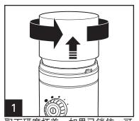
取下研磨杯盖,如果已锁住,可 逆时针方向旋转将其转到解锁位 置, 然后垂直上提将其取下。
