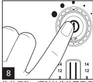
向上或向下拨动开关选择您要冲泡的杯数。顺时针旋转研磨度 设置旋钮以选择研磨的粗细。可参考第5页的图表选择研磨度和 杯数。按ON/OFF(开/关)(①)按钮启动研磨。完成选定的研磨 后. 研磨机将自动关闭。
