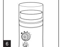
将研磨杯盖装到研磨机上。让研磨杯盖上的箭头与研磨机后方 的解锁标记对齐。顺时针旋转杯盖将其拧到锁定位置。听到 "咔哒"声即表示研磨杯盖锁定到位。
