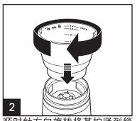
顺时针方向旋转将其拧紧到锁 住位置。确保研磨杯"牢固" 锁定到位。
