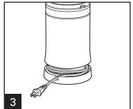
一只手抓住咖啡研磨机的同时,用另一只手向下拉底座。将电源线缠绕在底座的隐藏区域。 线沿着底座孔口缠绕,最后将插头放在底座外侧。上推底座收纳电源线。
