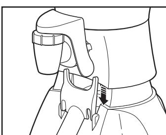
**NOTA:** El montaje de corte debe deslizarse entre la base y la palanca dispensadora para permitir que la palanca haga funcionar el dispensador.
