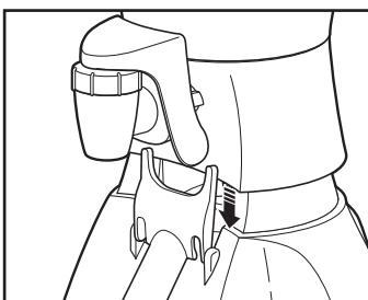
**NOTE :** Le mécanisme de coupe doit glisser entre la base et le levier du distributeur pour permettre au levier de bien distribuer.
