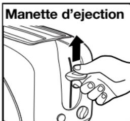
la manette pour mettre le grille-pain en fonctionnement. La manette peut être soulevée jusqu'au sommet pour interrompre le grillage durant un cycle. Pour soulever, placer l'index sous la manette et le pouce sur le bord du grille-pain directement au-dessus de la manette. La soulever fermement. À la
