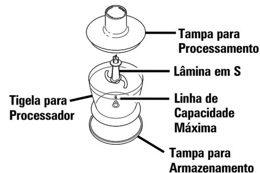
As tampas podem ser utilizadas para cobrir o Copo medidor e o miniprocessador ou podem ser colocados embaixo de cada um para proteger uma superfície.
