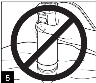
**OBS:** Não mergulhe a unidade de motor além da parte metálica superior de cada acessório.
