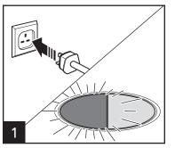
قم بتوصيل المقبس في مأخذ التيار الكهربائي سيضيءضوء التشغيل الأحمر
