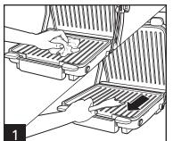
افصل المقبس عن المأخذ الكهر بائي واترك الآلة حتى تبردامسح سطوح الطهى بمنشفة ورقية لإزالة أى سوائل استخدم ملعقة بلاستيكية لكشط بقايا الطعام العالقة أوالشحوم
