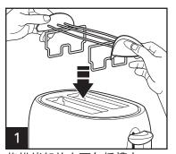
将烘烤架放在面包插槽上。
